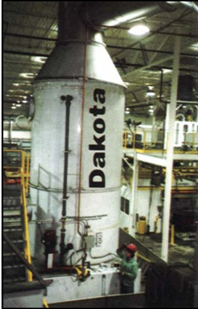
25,000 ACFM Dakota Scrubber™ éliminant les émissions de diméthyléthylamine (DMEA) du procédé des noyaux de gaz d'uréthane phénolique
